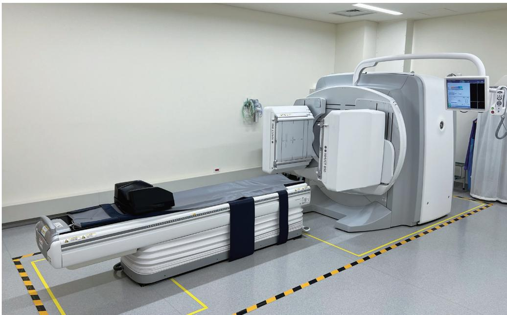
図1 吸収補正用CT搭載型SPECT装置NM/CT850
