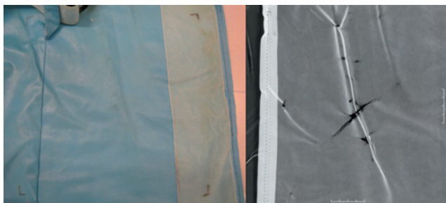
図6 防護衣の外観と透視画像(裂け目)
